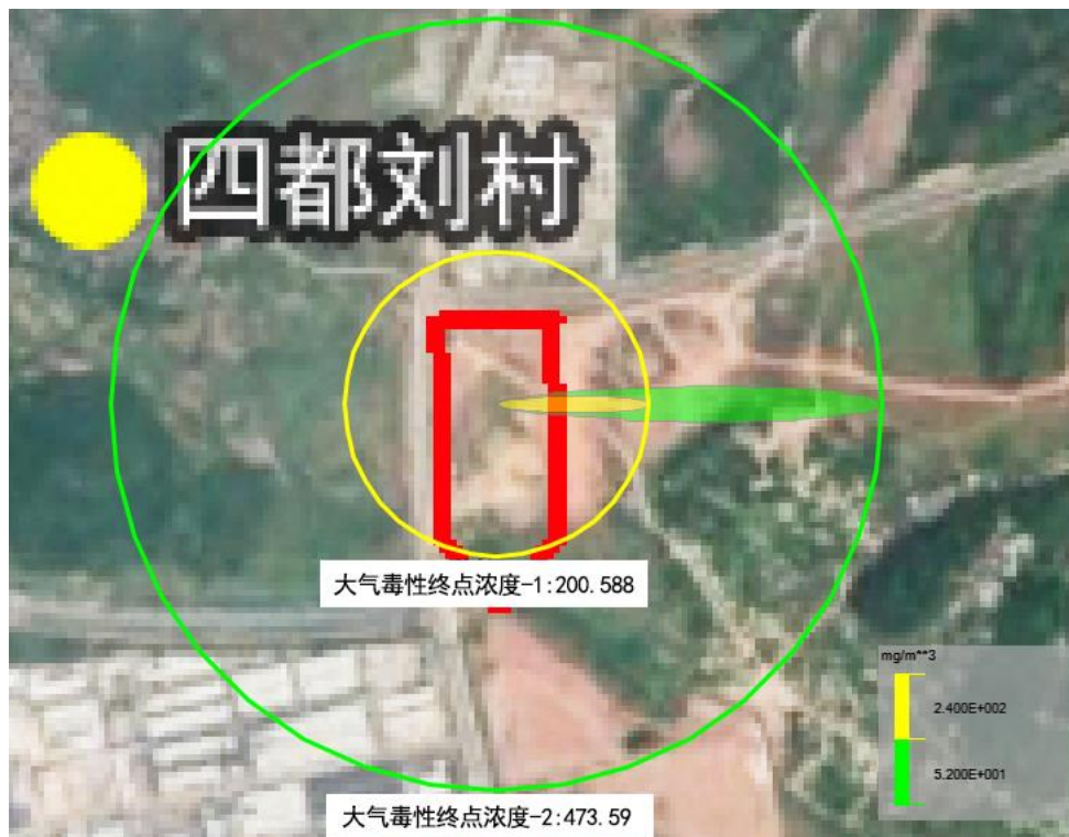
图 6.2-16 最不利气象条件下甲基二氯硅烷废气扩散预测结果图
