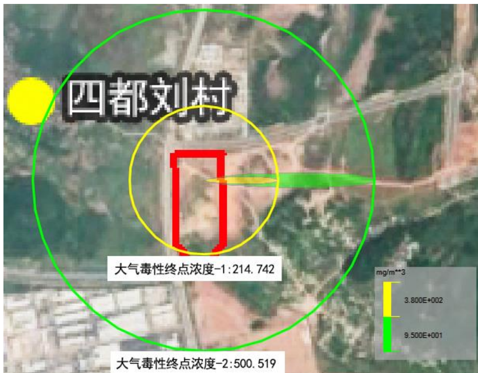
图 6.2-14 最不利气象条件下 CO 废气扩散预测结果图
