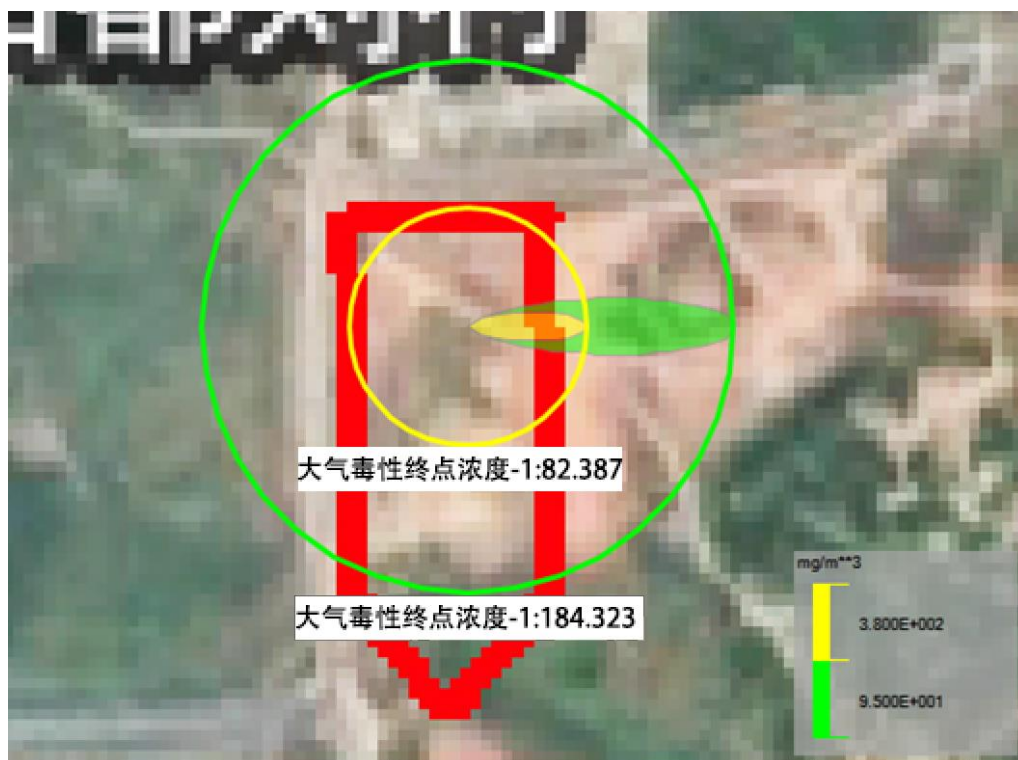
图 6.2-15 最常见气象条件下 CO 废气扩散预测结果图
